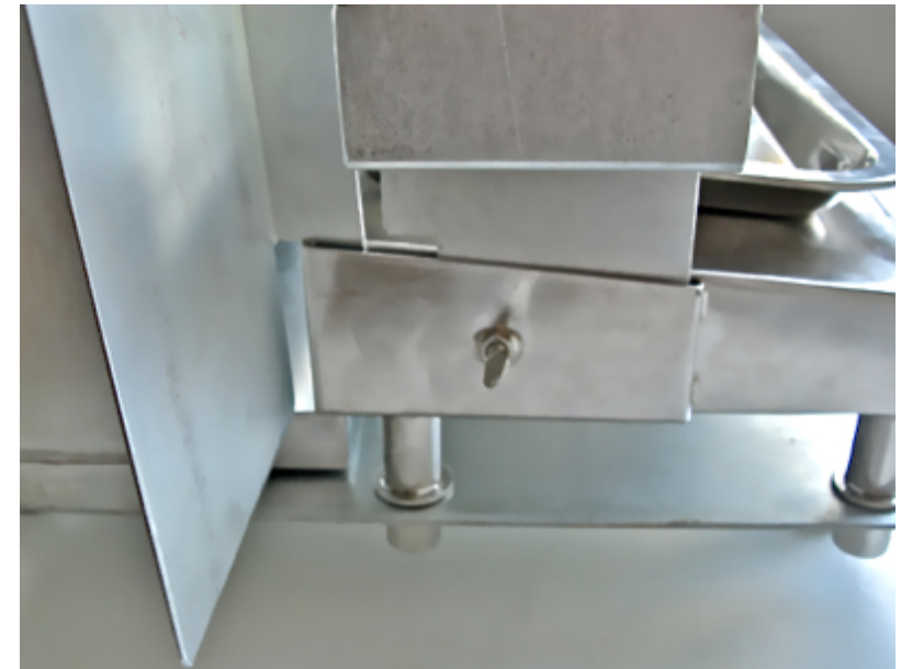
Halterung damit Distanz zum Feuer eingestellt werden kann
